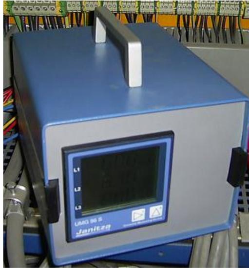
**Abbildung 26:** Speicher-Netzanalysator WL1
