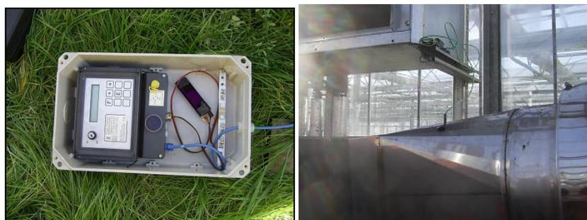
**Abbildung 28:** Einkanal-Datenlogger für Impuls und Temperatur
