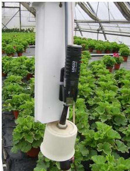
**Abbildung 30:** Temperatur-Feuchte-Logger
