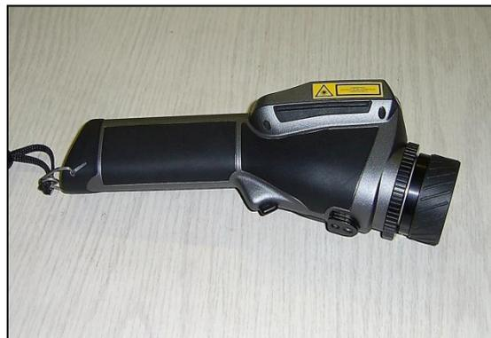
**Abbildung 24:** Thermokamera Typ FLIR Cam E2
