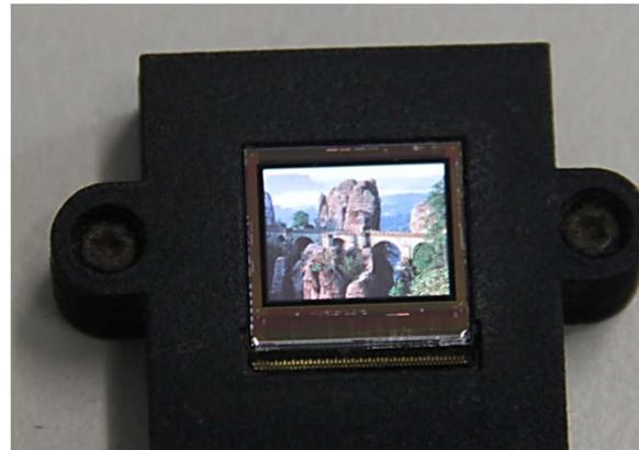
OLED-Mikrodisplay + CMOS Bildsensor
