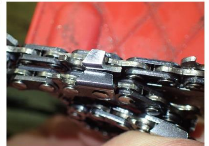
Abb. 06: Modifizierte Kette (oben) für Carving-Schwert
