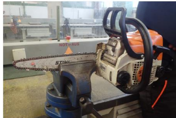
Abb. 05: Säge mit Carving-Schwert
