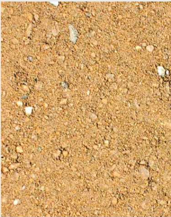
Die dynamische Schicht HanseMineral o/16 erfüllt DIN 18035-5 und eignet sich u.a. zum Nachprofilieren.
