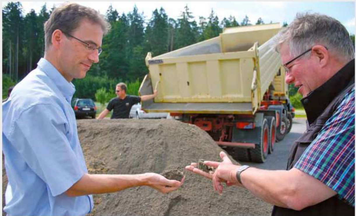
Leicht erdfeucht, so soll es sein! Guido Schilling (links) und Hans Pape prüfen die vom Schotterwerk Bad Neustadt angelieferte HanseGrand Franken Deckschichtmischung.
