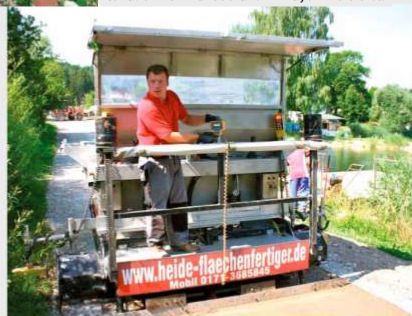
Der kompakte Fertiger kann mit Ultraschall, Laser und Querreinigungssensoren gesteuert werden, je nachdem welche Flächen damit bearbeitet werden sollen.
