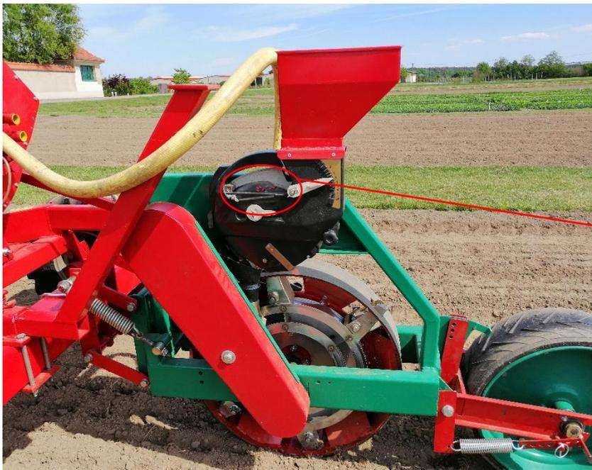
**Abb. 1: Aussaat der Horstsaat-Variante mit dem ‚Polyplanter‘** (kleines Foto: eine der Gruppen mit jeweils 6 Löchern auf der Sä-scheibe, hier allerdings mit insgesamt 7 Korn belegt; Foto: FLÄMIG)
