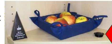
Messung der Radonkonzentration mit einem Radondosimeter (kleine schwarze Kapsel rechts) zum Vergleich mit dem Referenzwert
