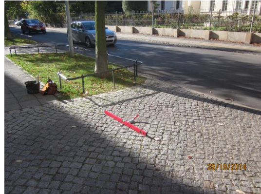
Abb.: Messung der Ebenheit
