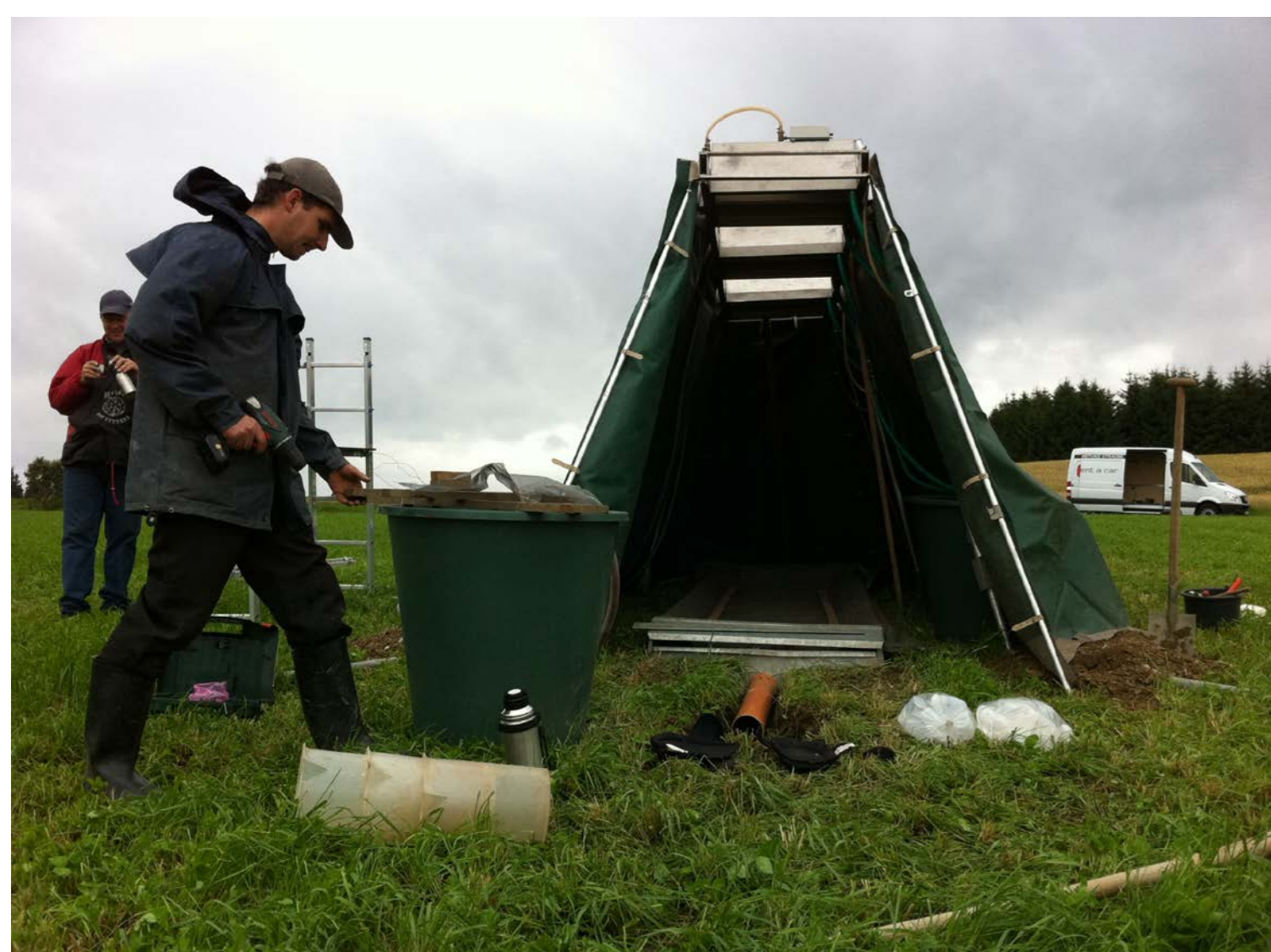
Beregnungsanlage zur Durchführung von Erosionsversuchen
