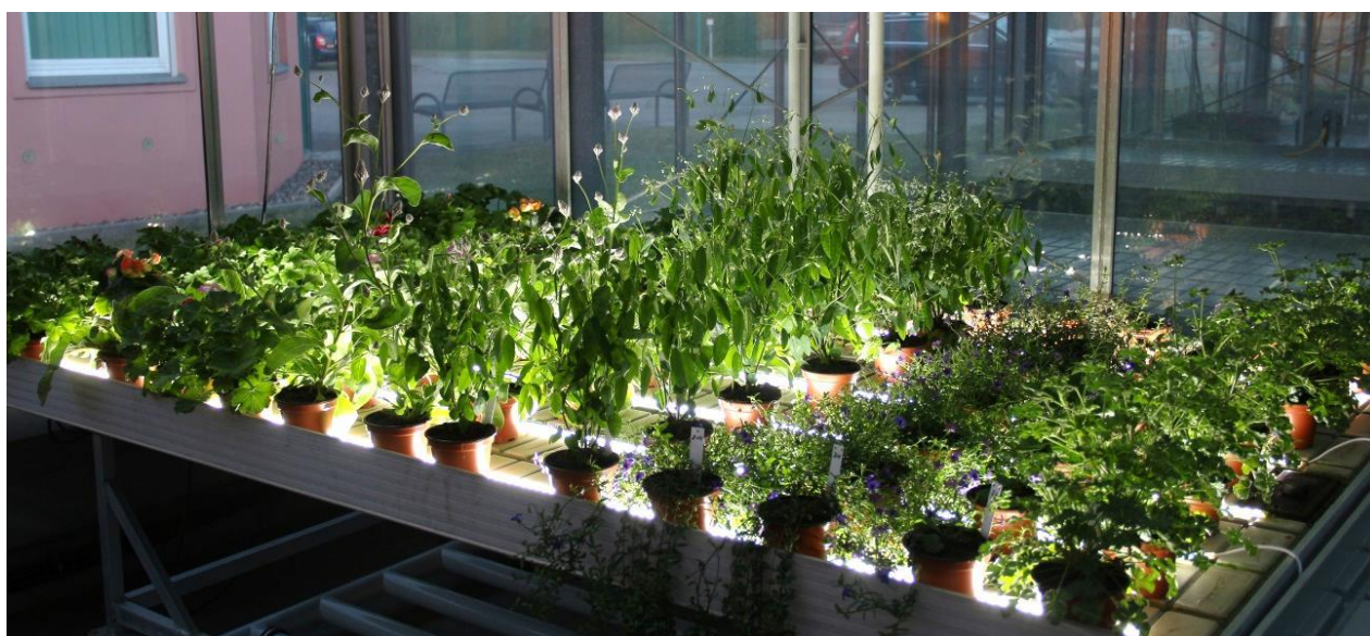
Abbildung 1: Anstautisch mit LED-Belichtung von unten (LfULG Dresden-Pillnitz 2015)
