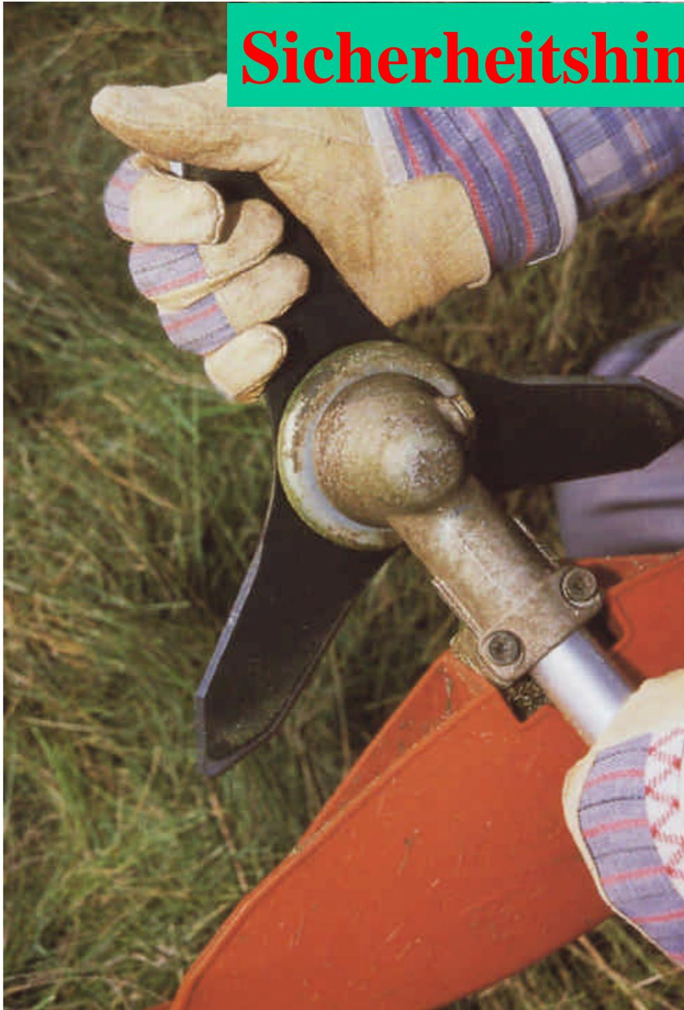
**Überprüfen Sie vor Arbeitsbeginn den einwandfreien Zustand der Werkzeuge und der dazugehörigen Schutzeinrichtungen. Beschädigte Werkzeuge müssen sofort ausgetauscht werden.**
