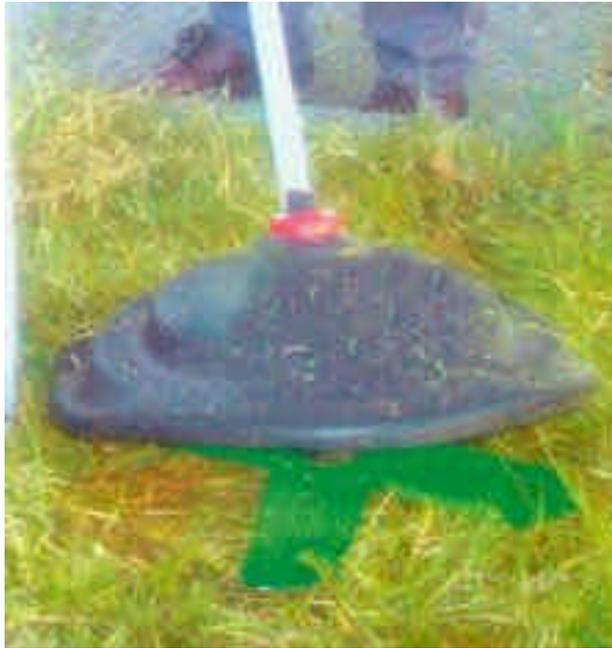
**Im Handel sind spezielle Freischneidervarianten erhältlich, bei denen sich durch ihre Arbeitsweise der Gefahrenbereich deutlich reduzieren lässt.**
