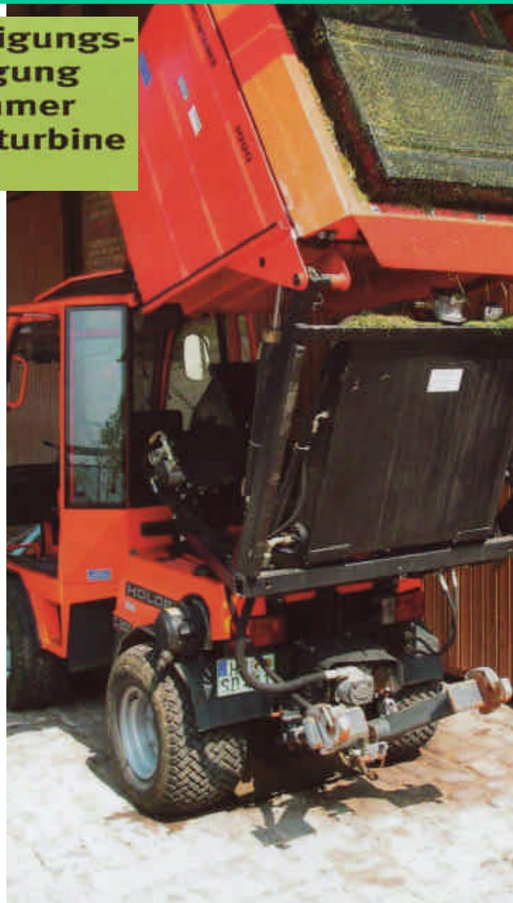
Verwenden Sie eine Abstützung, wenn Sie sich z.B. für Reinigungsarbeiten unter dem hydraulisch angehobenen Mähcontainer aufhalten – Achtung: Lebensgefahr bei plötzlichem Druckverlust im Hydrauliksystem!
