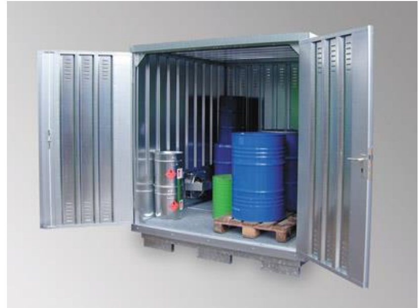
Sicherheits-Lagerhaus für die Lagerung wassergefährdender Stoffe, zur Aufstellung in Gebäuden oder im Freien, auf ebenem und befestigten Grund, aus verzinktem Stahlblech, mit integrierter Auffangwanne und Gitterrostaufgabe als Boden
